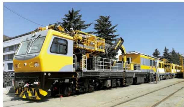
実績紹介：ハイブリッドトランスミッションTACHN搭載作業車(中国)
