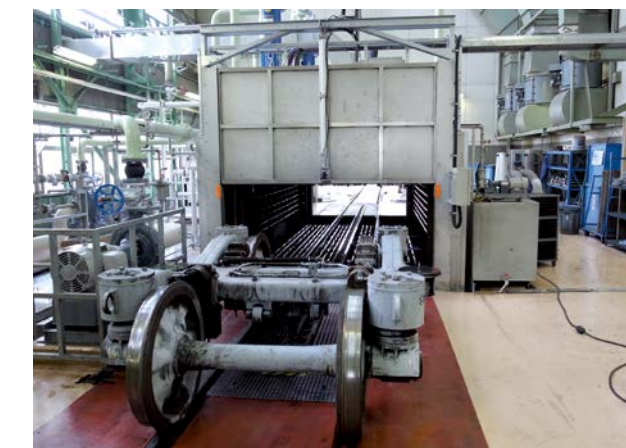
台車洗浄装置
