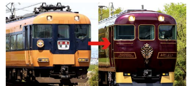
近鉄12200系(スナックカー)を19200系(あをによし)に車体更新
