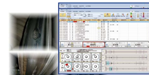
車輪フラット検出装置
